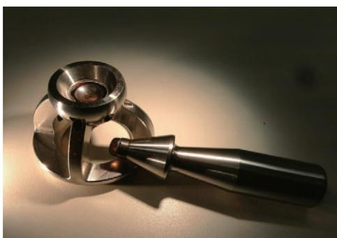
GRCでは超高硬度ナノ多結晶ダイヤモンド（ヒメダイヤ）の開発に成功して以来、その様々な分野への応用をすすめています。その一環として、入船GRCセンター長らはヒメダイヤを用いた世界で最も硬い乳鉢と乳棒を作製しました。このたびこれを用いた最初の研究成果が、アメリカ物理学会のRev. Sci. Instrum. 誌に発表されました。本研究はヒメダイヤ乳鉢と乳棒で粉碎した半導体ダイヤモンドを用いることにより、超高压下で従来にない高い温度を発生できることを示したものであり、ヒメダイヤ利用の新たな可能性を示すもので
