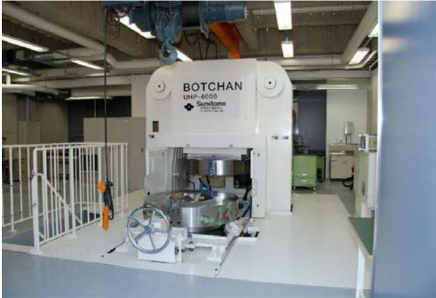
このほどGRCの入っている総合研究棟に隣接して増築された4階建ての建物に、現存するマルチアンビル装置としてはバイエルン地球科学研究所(パイロイト)や岡山大学(三朝)の5000トン装置を凌ぎ、世界最大となる6000トン駆動マルチアンビル装置(BOTCHAN-6000)が完成しました。既に15万程度の圧力下で、大型ナノ多結晶ダイヤモンド(ヒメダイヤ)の合成などが開始されています。BOTCHANは“Beyond Observable Toughness and Conceivable Hardness of Artificial Nano-diamond”の略で、人工ナノダイヤモンドの強度と硬さを越える新物質の合成を目指すという意味が込められています。
