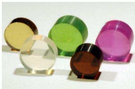
入船センター長らのグループは、通常の焼結法と比べてはるかに高い10万気圧以上の超高压と、1400℃程度の温度を加えることにより、透明ナノセラミックスの一種である「透明ナノ多結晶ガー
