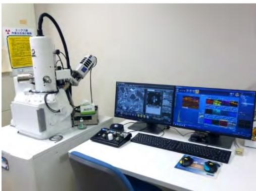
本装置（日本電子製 IT-500HR）は、主に高压実験後の回収試料の微細組織観察や鉱物相の同定、化学組成分析を行うための装置で、2020年3月に当センターに納入・設置されました。GRCでは2005年に導入した同タイプの装置（同社製 JSM-7000F、EDS および EBSD 検出器付き）が長らく主力装置として務め、これまで多くの先端研究の推進に貢献してきましたが、老朽化により真空系や操作系、電子銃周りなど故障が頻発し、ここ数年は修理対応に追われる状況でした。加えて、平成25年に共同利用・共同研究拠点（PRIUS）がスタートして以来、国内外の研究者からの使用要請も多く、GRC 学生の卒論・修論研究が本格化する年度後半などは予約がかなり混雑している状況でした。SEM-EDS による微細組織観察と化学組成分析は、X 線回折やラマン分光分析などと並んで、高压合成試料のキャラクタリゼーションを行う上で、今や最も基本的かつ必須のルーチンであるため、実質的な後継として本装置を導入するに至りました。
