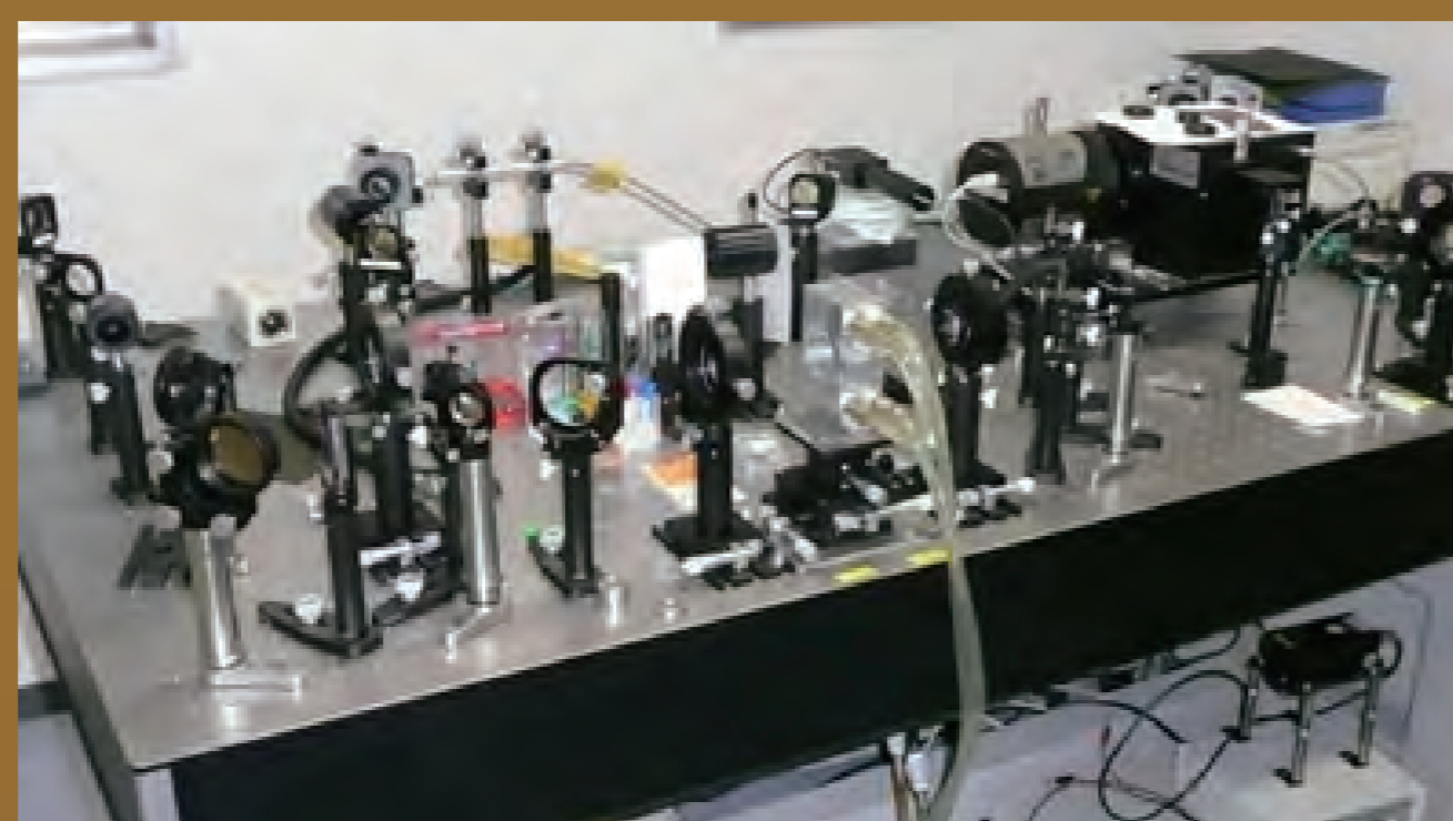
地球中心核を超える高温・高圧状態を再現するダイヤモンドアンビル装置
